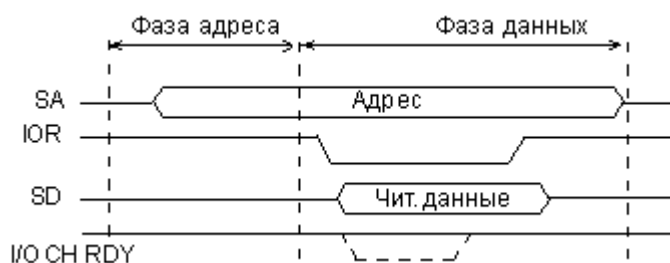
Рис. 17 Цикл чтения из УВВ на магистрали ISA.
