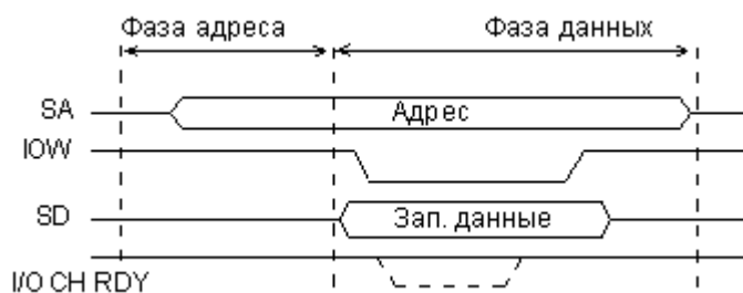
Рис. 18 Цикл записи в УВВ на магистрали ISA.
