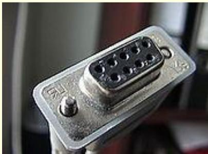
Наиболее часто используются D-образные разъёмы: 9-ти и 25-тиконтактные, (DB-9 и DB-25 соответственно).
