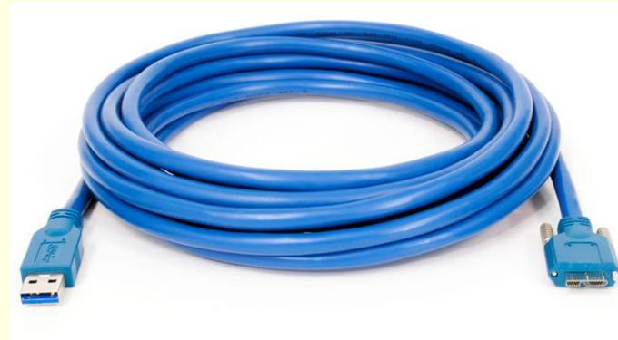
Кабель USB 2.0 содержит в себе четыре линии — пару для приёма/передачи данных, плюс и ноль питания. В дополнение к ним USB 3.0 добавляет ещё четыре линии связи (две витые пары), в результате чего кабель стал гораздо толще.
