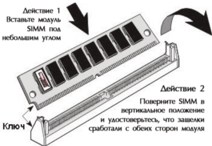
Рисунок 31: Установка модуля SIMM
