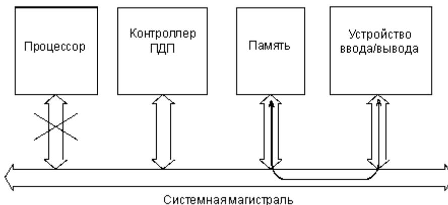
Рисунок 4: Информационные потоки в режиме DMA.
