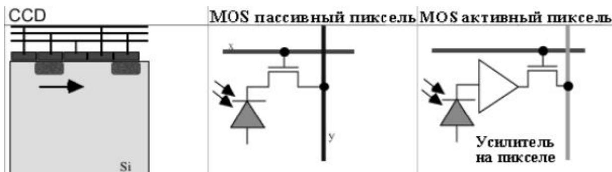
Рисунок 10: Сравнение элемента CCD, MOS-пассивного пикселя и MOS-активного пикселя
