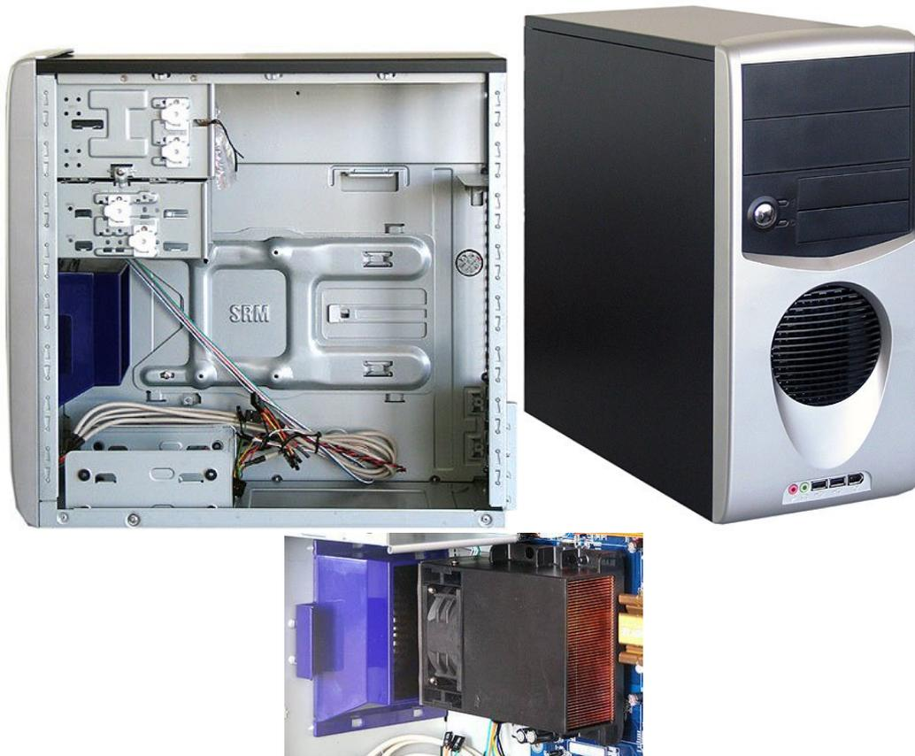
Рисунок 40 Корпус ВТХ и вентилятор
