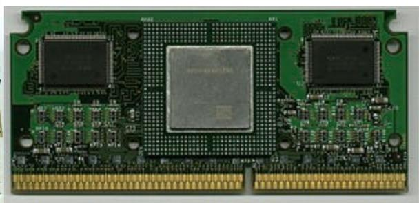
**Рисунок 13 Разъем Slot 1 (Intel) и процессор**
