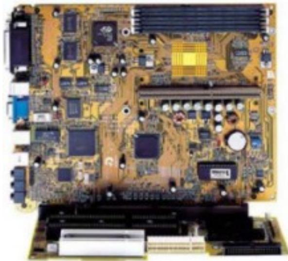
**Рисунок 31** Вариант монтажа NLX
