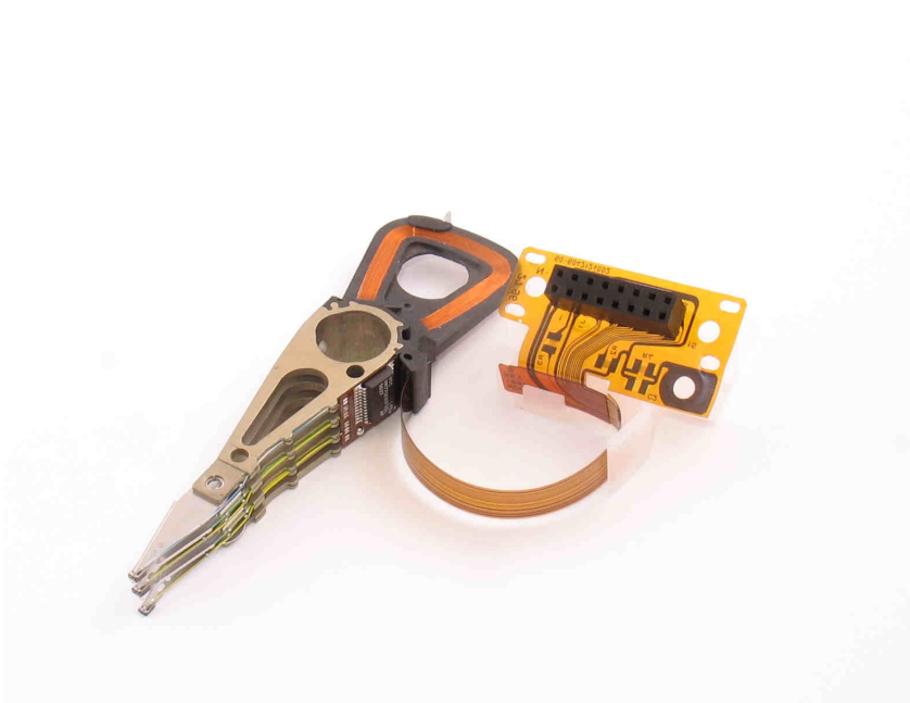
Рисунок 8.25 Разъём, гибкий шлейф, микросхема усилителя — смонтированы на подложке из полиимида.
