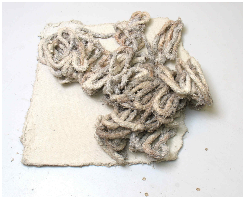
Рисунок 6.21 Кусок асбестокартона и старый грязный асбестовый шнур. Асбест на ощупь очень мягкий и не колется как стеклоткани.
