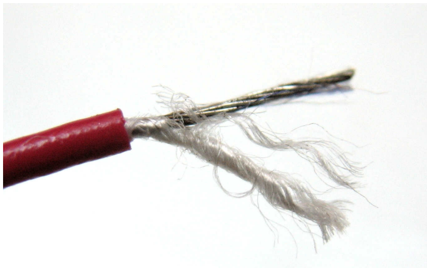
Рисунок 7.4 Провод марки МГШВ 67 имеет две изоляции — из полиэфирной нити и из ПВХ
