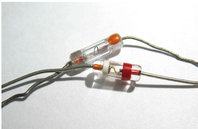
Рисунок 6.9 Корпуса этих полупроводниковых диодов изготовлены из стекла.
