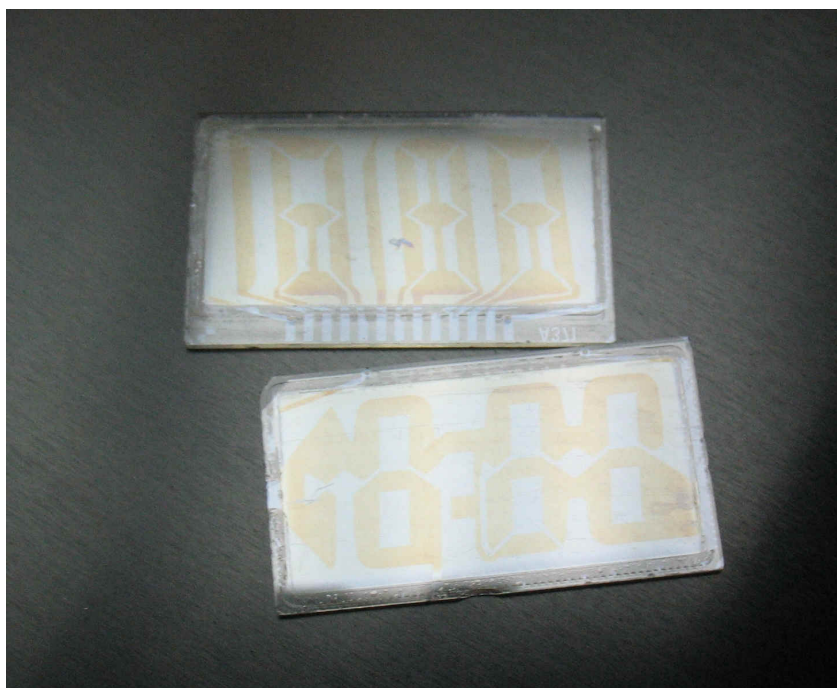
Рисунок 3.6 Стекла от ЖК индикатора электронных часов. Индикатор подключался к электронной схеме через токопроводящую резинку, гребенка контактов видна в нижней части стекла.
