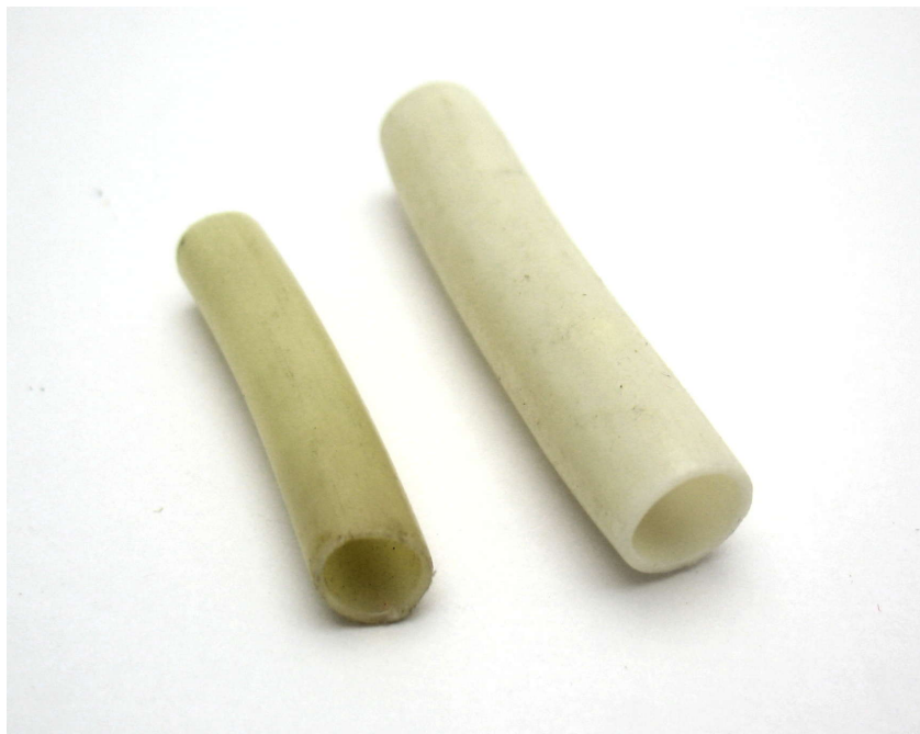
Рисунок 10.2 ПВХ трубка набухающая в ацетоне рядом с исходной трубкой. Диаметр трубки увеличился почти на треть.
