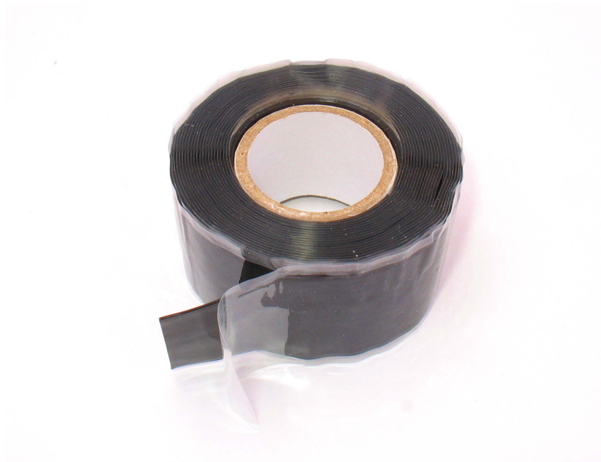
Рисунок 9.8 Рулон самослипающейся силиконовой изоленты. Защитный тонкий слой удаляется во время намотки, а сама лента натягивается, плотно обвивая соединение.
