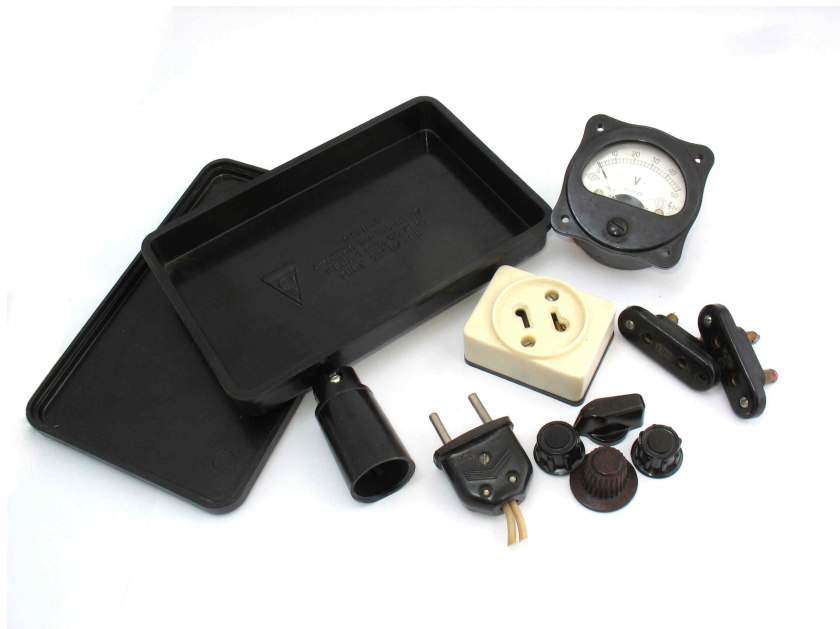
Рисунок 8.2 Различные изделия из карболита — коробочка, розетка. Вилка, корпус вольтметра, гнезда, ручки регулировки.
