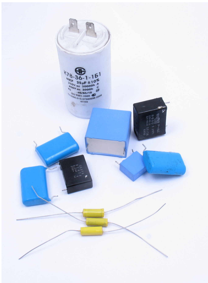
Рисунок 8.16 Различные пленочные конденсаторы. Белый конденсатор на заднем фоне имеет полипропиленовую изоляцию.
