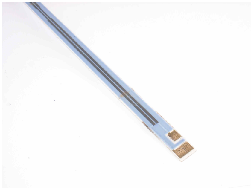
Рисунок 3.2 Нагреватель от печи лазерного принтера. Основа — фарфор, проводники — серебро. Нагреватель — углеродная композиция, покрыта для защиты слоем глазури.
