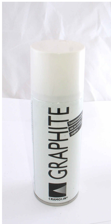
Рисунок 3.1 Токопроводящий лак на базе мелкодисперсного графита. Покрыв пластиковую деталь таким лаком её электропроводность становится достаточной для выращивания слоя металла методом гальванопластики.
