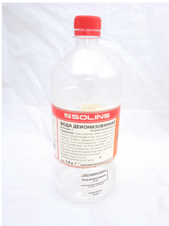
Рисунок 6.23 Бутылка деионизированной воды из радиомагазина. Печатные платы электронных устройств стоит промывать только дистиллированной или деионизированной водой, иначе соли, содержащиеся в воде, могут наделать бед.
