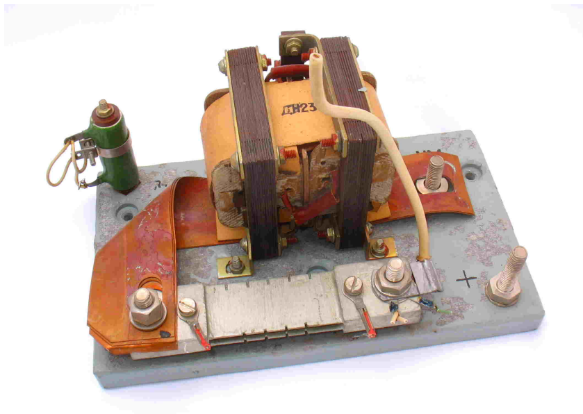
Рисунок 6.22 Магнитный усилитель и токовый шунт от блока питания 50-ВУК-120-1 на плате из материала на базе асбеста.
