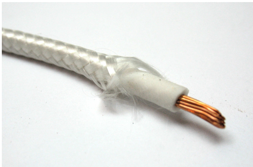
Рисунок 8.24 Провод РКМ 2,5 — термостойкий провод с изоляцией из кремний-органической (силиконовой) резины, многожильный с наружной оплеткой из стекловолокна. Рабочая температура -60^{\circ}\text{C} +180^{\circ}\text{C}
