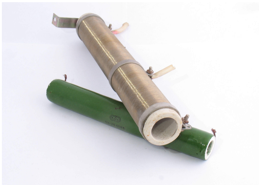
Рисунок 6.5 Мощные резисторы имеют основу из фарфоровой трубки. У зеленого резистора обмотка скрыта под эмалью.
