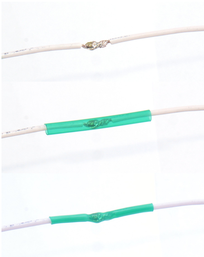
Рисунок 10.7 Паяное соединение, надвигаем подходящую по диаметру термоусадочную трубку и нагреваем. После усадки трубка надежно зафиксирована.
