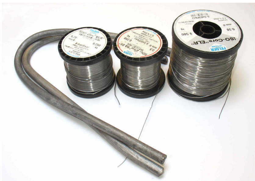
Рисунок 4.1 Катунки и прутки оловянно-свинцовых припоев. Проволока из припоя содержит центральный канал с флюсом, облегчающим процесс пайки.
