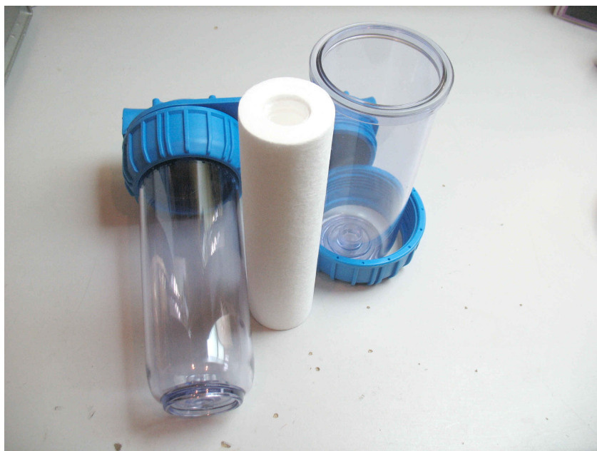
Рисунок 8.15 Фильтрующий картридж из полипропилена для фильтров воды. Полипропиленовые волокна навиты и спрессованы так, что задерживают частицы крупнее 5 мкм.
