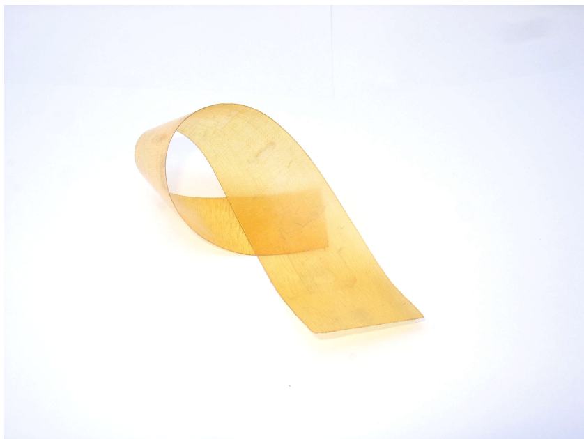
Рисунок 8.11 Кусочек лакоткани. Часто можно встретить в трансформаторах.
