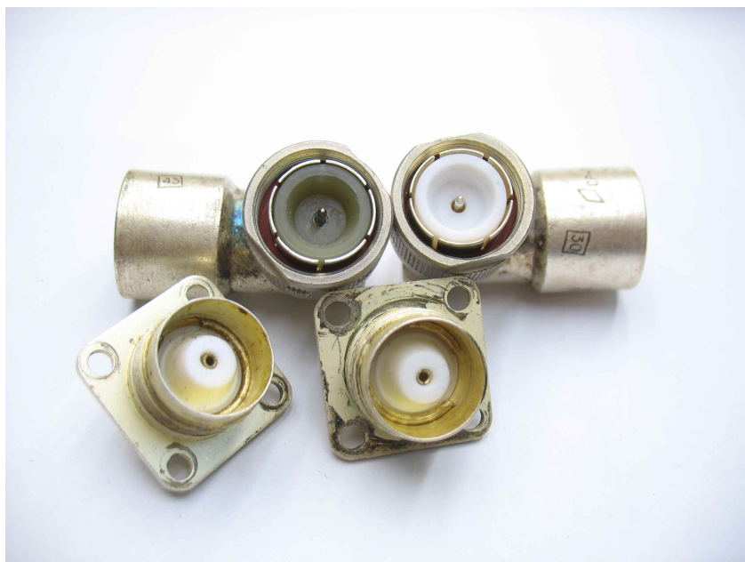
Рисунок 8.17 Высокочастотные разъемы. Изолятор левого изготовлен из полиэтилена, правого — из фторопласта. Корпуса разъемов посеребрены.
