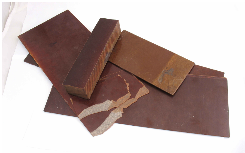
Рисунок 8.4 Различные изделия из гетинакса. Пластина специально была сломана, чтобы показать характерный рисунок на изломе. Гетинаксовый брусок слегка распух справа — результат расщепления слоев при резке.
