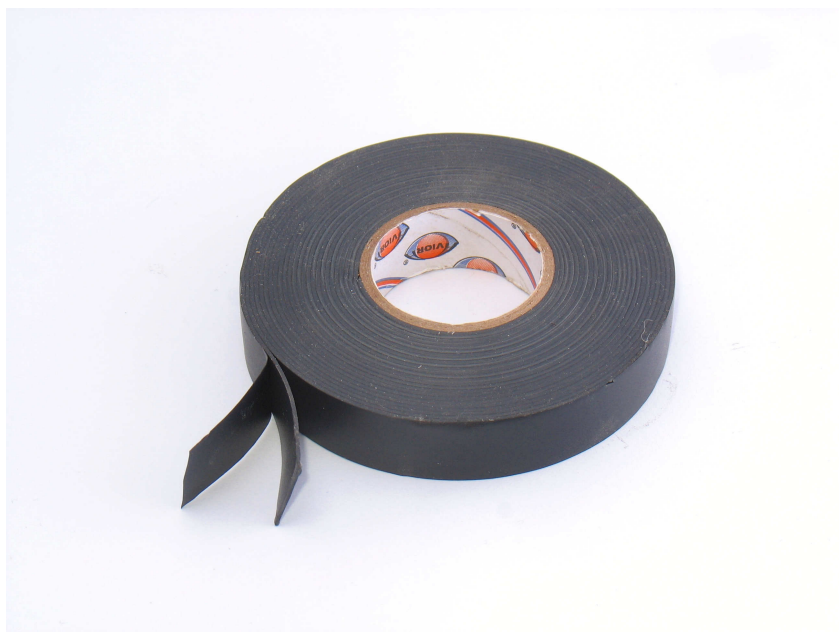
Рисунок 9.7 Рулон самослипающейся (самовулканизирующейся) изолен- ты. За- щитный тонкий слой удаляется во время намотки, а сама лента натягивается, плотно обвивая соединение.
