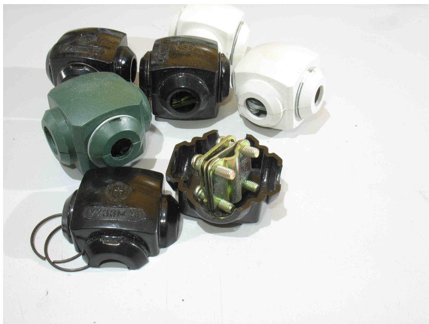
Рисунок 2.12 Соединитель «орех». Внутри пластиковой оболочки комплект стальных пластин с винтами, позволяет сделать ответвление от жилы кабеля не разрезая саму жилу. Также позволяет перейти от алюминиевой жилы на медную.
