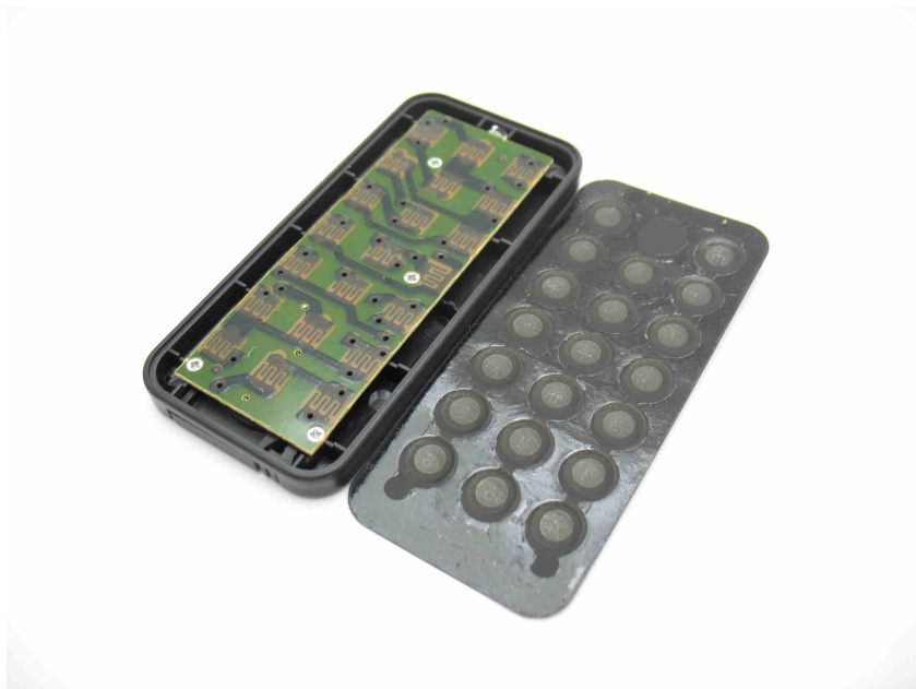
Рисунок 3.5 Пульт дистанционного управления. Контактные площадки на печатной плате, проводники, проводящее покрытие на кнопке изготовлено из графитового покрытия.
