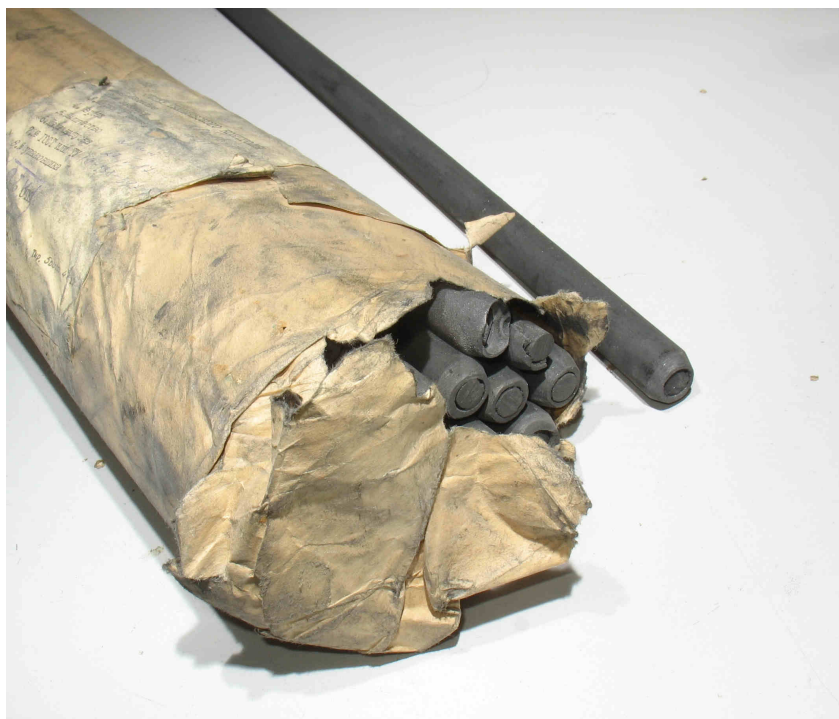
Рисунок 3.3 Электроды от дуговой лампы, использовавшейся для киносъёмок. Марка электродов КСБ — Уголь КиноСъёмочный Белопламенный неомеднённый.
