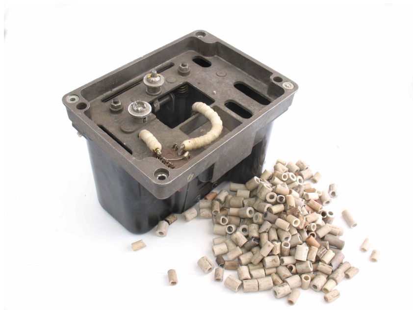
Рисунок 6.1 Корпус ртутной дуговой лампы от светолучевого осциллографа. Рама из алюминиевого сплава, чёрный корпус — карболит, фарфоровые бусы изолируют проводники, которыми подключается лампа. Лампа очень сильно нагревается во время работы. Рядом кучка цилиндрических фарфоровых бус от различных нагревателей.
