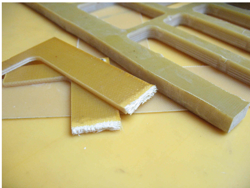
Рисунок 8.10 Обрезки листового стеклотекстолита различной толщины. Деталь на переднем плане специально была сломана — на изломе виден текстильный материал.
