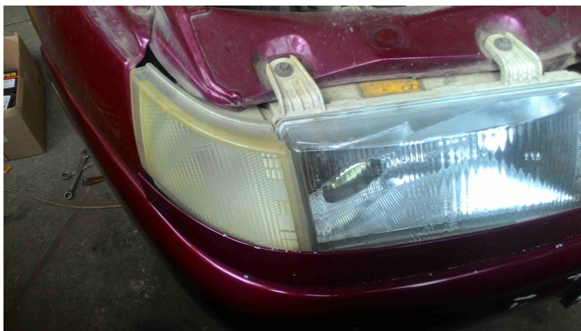
Рисунок 8.29 Фары автомобиля. Левая изготовлена из поликарбоната и от воздействия солнца пластик помутнел. Правая изготовлена из силикатного стекла и устойчива к солнечному свету.
