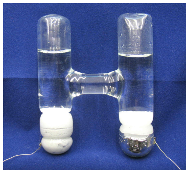
Рисунок 2.20 Элемент нормальный насыщенный, НЭ-65, класс точности 0,005. Внешний вид корпуса нормальных элементов может различаться. Справа - содержимое корпуса, видна ртуть в нижней части колб. Такие элементы должны утилизироваться специализированной организацией.
