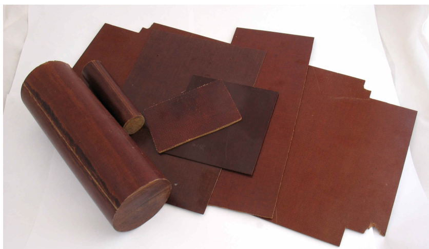
Рисунок 8.6 Текстолит различных форм — пластины, прутки. Расположение ткани в материале различается — у прутков ткань намотана, а не уложена слоями.
