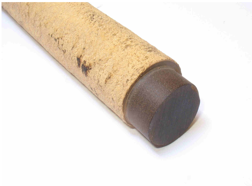
Рисунок 7.7 Эбонитовый пруток. Я сточил часть прутка для видимости самого материала.
