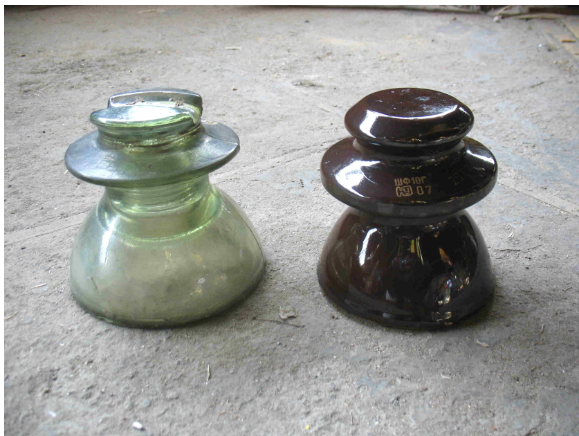
Рисунок 6.7 Стекланный и фарфоровый изолятор линий электропередач проработавший на улице более 30 лет.
