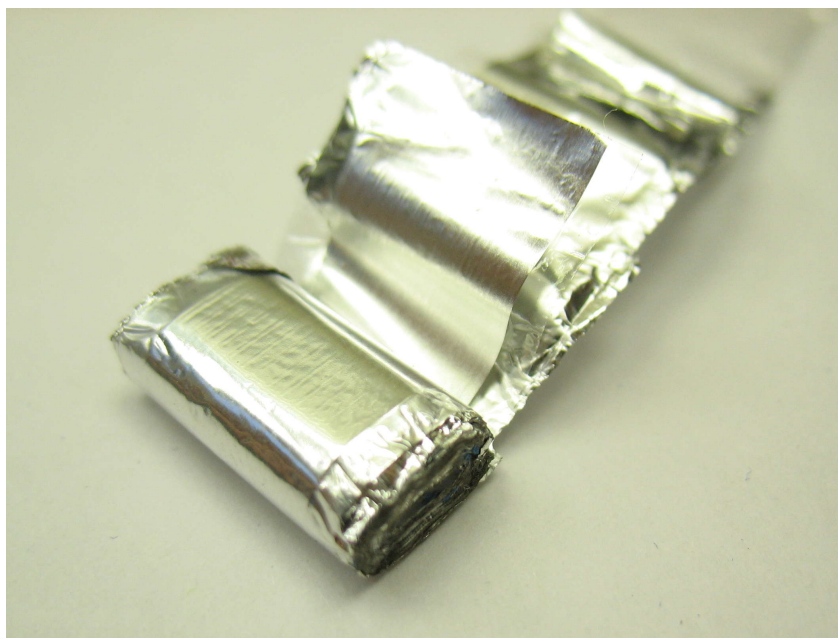
Рисунок 8.21 Фольговый пленочный конденсатор с изоляцией из полиэтилентерефталатной пленки.
