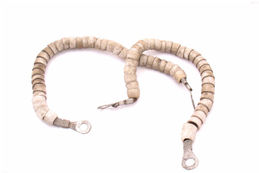
Рисунок 6.2 Проводники в изоляции из фарфоровых бус для работы рядом с мощной дуговой ксеноновой лампой кинопроектора
