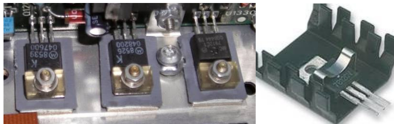
Рисунок 9 Установка TO220 с охлаждением
