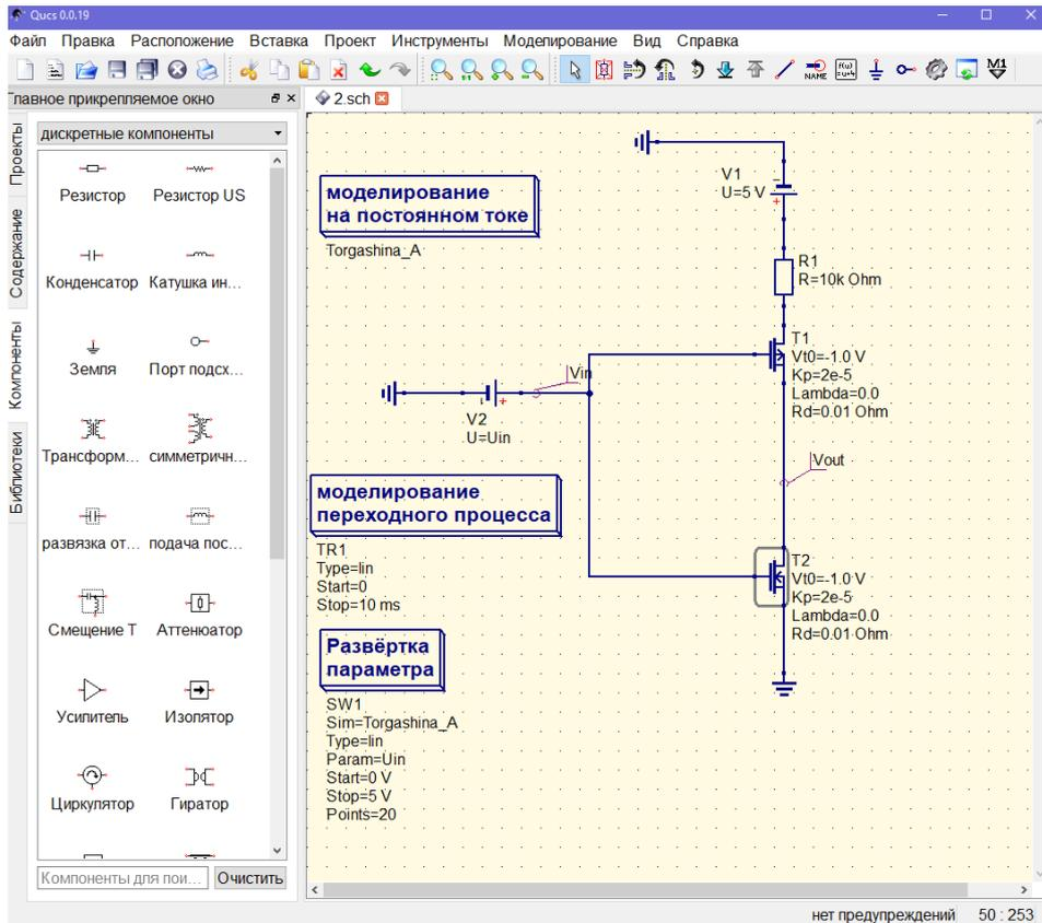
Далее нажимаем «Моделирование» и выбираем «Моделировать»
