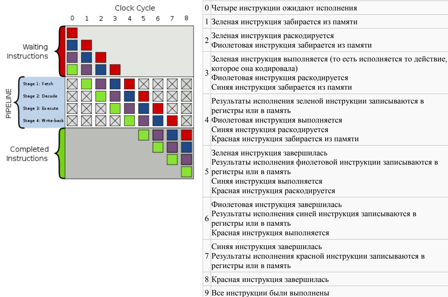
Рисунок 9 Общий четырехуровневых конвейер; цветные квадраты символизируют независимые друг от друга инструкции
