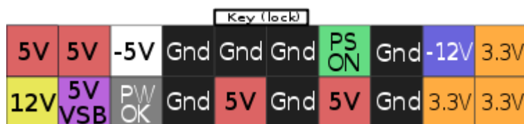
Рисунок 20 Распиновка разъема Motherboard ATX
