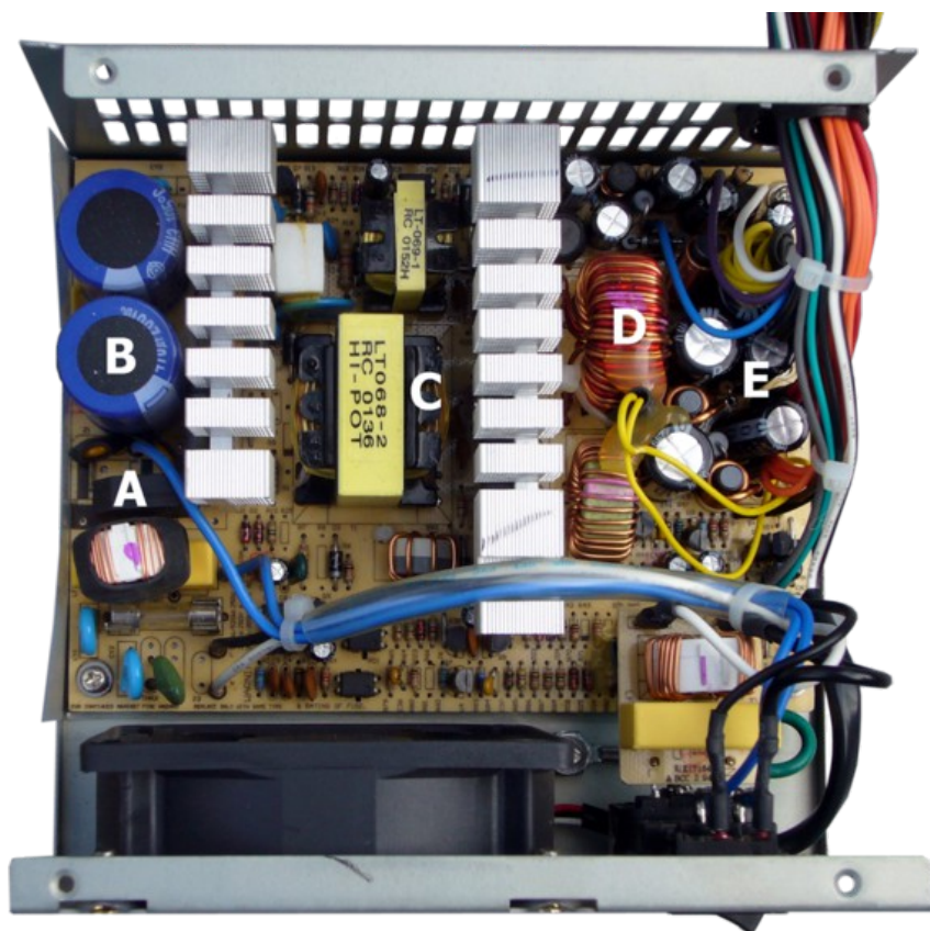
Рисунок 15 Блок питания АТХ - вид изнутри
