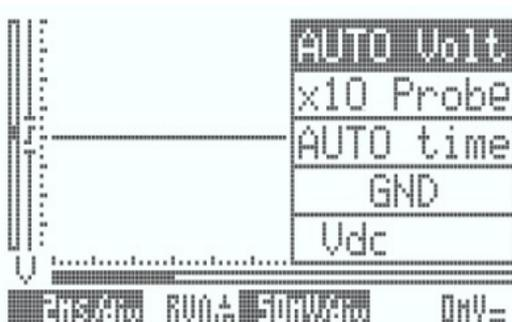
AUTO Volt - увеличение или уменьшение вертикально сигнала путем корректировки напряжения на деление, или можно выбрать AUTO для автоматического отображение сигнала на дисплее
