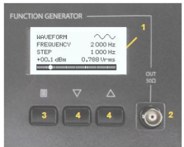
WAVEFORM - Выберите нужный сигнал (синус, квадрат или треугольник)
