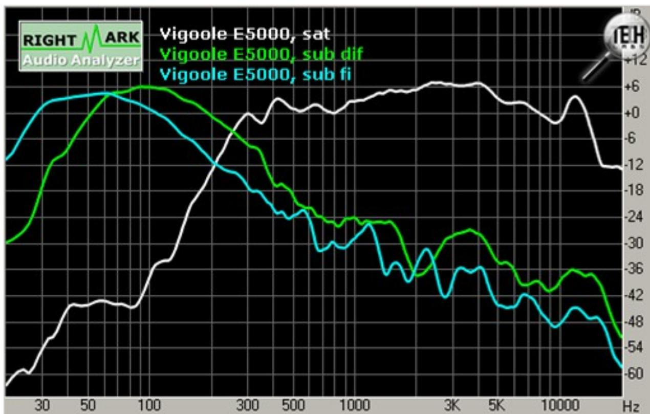
Рисунок 29 АЧХ сателлита, сабвуфера, сабвуфера с фазоинвертором
