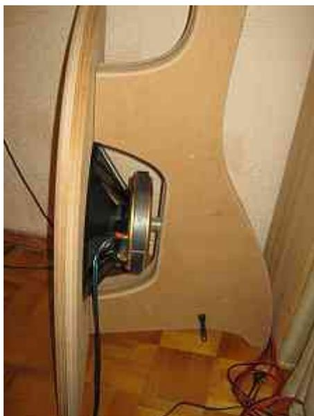
Рисунок 20 акустический щит(экран) – открытый корпус
