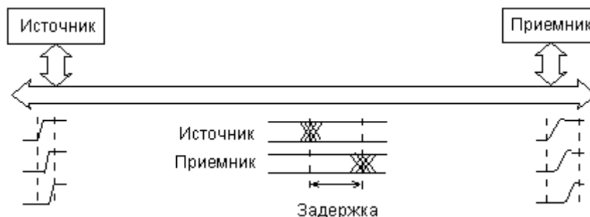
Рис 23. Прохождение сигналов по шине.
