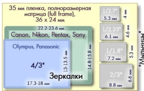
Рисунок 15: Физические размеры фотоматриц
