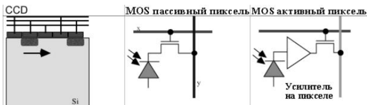
Рисунок 14: Сравнение элемента CCD, MOS-пассивного пикселя и MOS-активного пикселя
